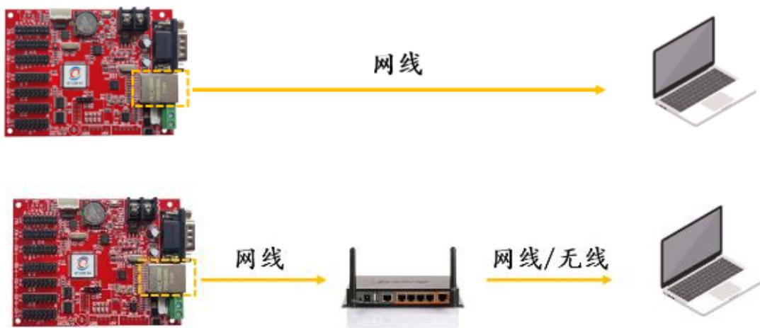
② 使用参数配置软件搜索控制卡，配置显示屏参数和控制卡的 IP 地址，**通讯接口**修改为**网络服务器端 (单点使用)** (单点使用)
